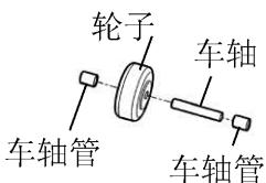
③ 在底座的内侧凹槽部位装上步骤②组装完成的轮子。
