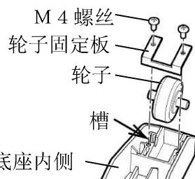
步骤③完成后，装上轮子固定板，并用 M4 螺丝锁紧。
