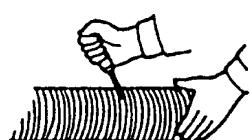
② 拆下冷风管的槽，用剪刀或斜口钳剪断。
