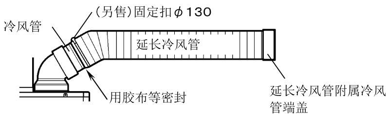
延长冷风管附属冷风管端盖
