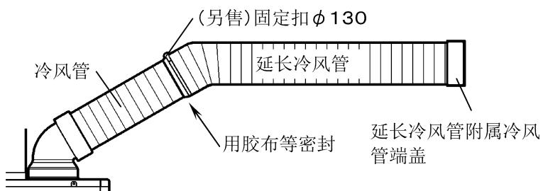
延长冷风管附属冷风管端盖
