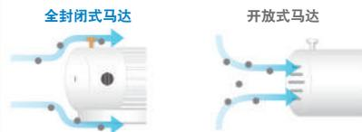
全封闭式马达可防止粉尘及油雾进入马达内部，从而避免由此而引起的故障和火灾等。SUIDEN的工厂扇采用“全封闭式马达”。
