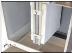
在过滤器面积不变的情况下，使滤网更加紧凑化。因为增加了滤网的个数，所以有效过滤面积是以往机器的2倍。
