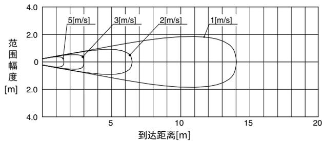
※测试高度：风扇出风口中心。（离地面高度约1m）
