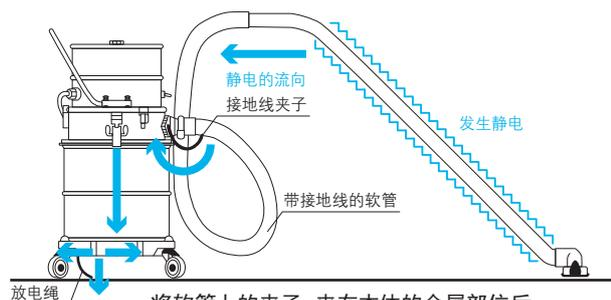
将软管上的夹子，夹在本体的金属部位后，所产生的静电会被导入本体的金属部分，由放电绳释放出去。
