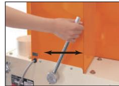
操作更简单，只需前后摇动除尘杆即可。除尘杆装置可以根据需要自由地安装在主机左侧或右侧。
