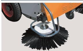
可将周围的垃圾向中央聚集，提高清扫作业的效率。另外，还可将堆积在墙壁旁及栅栏旁的垃圾聚集起来清扫干净。
