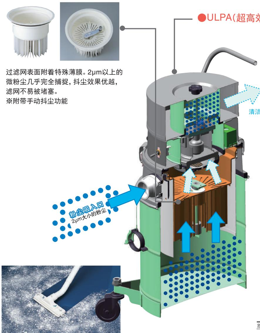
主过滤器捕捉2 $\mu$ m以上的粉尘。而且具有优越的抖尘效果!
