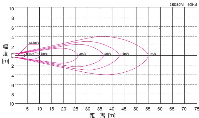
※测试的高度为扇叶的中心高度。
