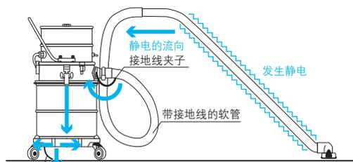
将软管上的夹子，夹在本体的金属部位后，所产生的静电会被导入本体的金属部分，由放电绳释放出去。
