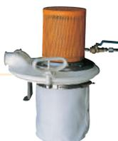
吸取液体时, 应取下过滤网。当吸取物装满储尘桶后, 内部的浮子就会使吸取停止, 以防止溢出。
