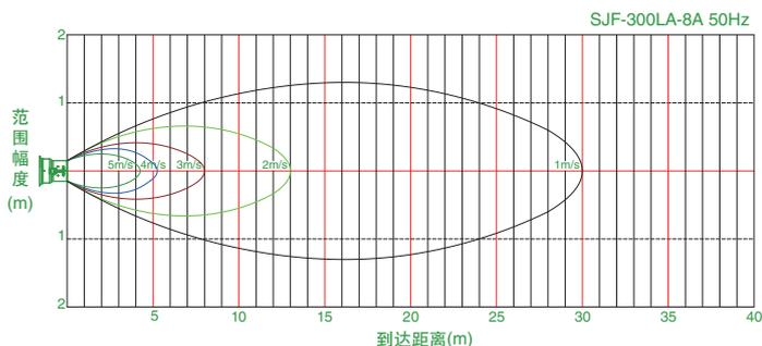
※测试的高度为扇叶的中心高度。
