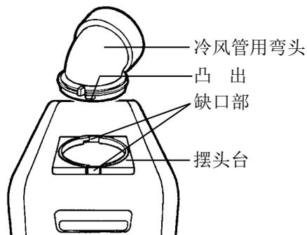
② 冷风管用弯头的扣位对着摆头台的「固定」位置
